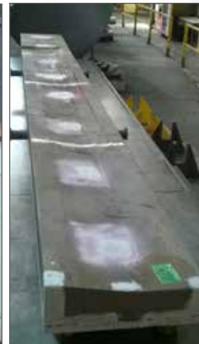
Rotor blade mold Ferrynox A36 8m long
